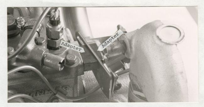
7. Demontera gasvirekonsollen, återmontera fästet med adaptern med det grövre mellanstycket närmast motorn (se bild). M6x25mm.
