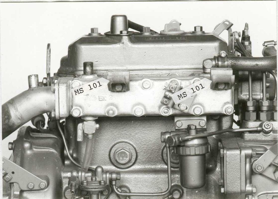
6. Montera MS 101 fästena med skålarna uppåt med M8 x 110mm, använd 2 st distansbrickor, mellan fästet och avgassamlaren. Drag ej skruvarna för hårt (se bild).
