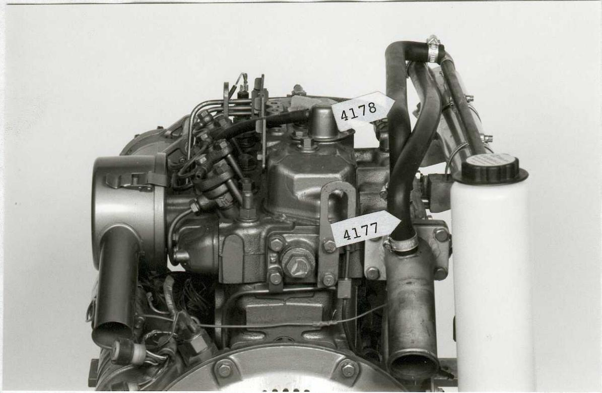
9. Monterar den formgjutna slangen nr 4177 mellan värmeväxlarens övre 90°-anslutning, riktad akterut, till avgaskrökens slanganslutning (sjövatten ut).
