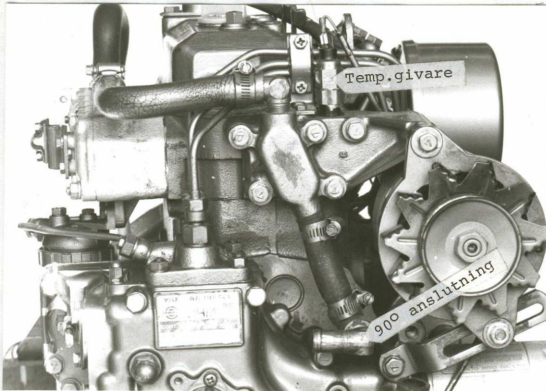
2. Demontera slangen mellan sjövattenpumpens trycksida och till inloppsrören i motorn.
