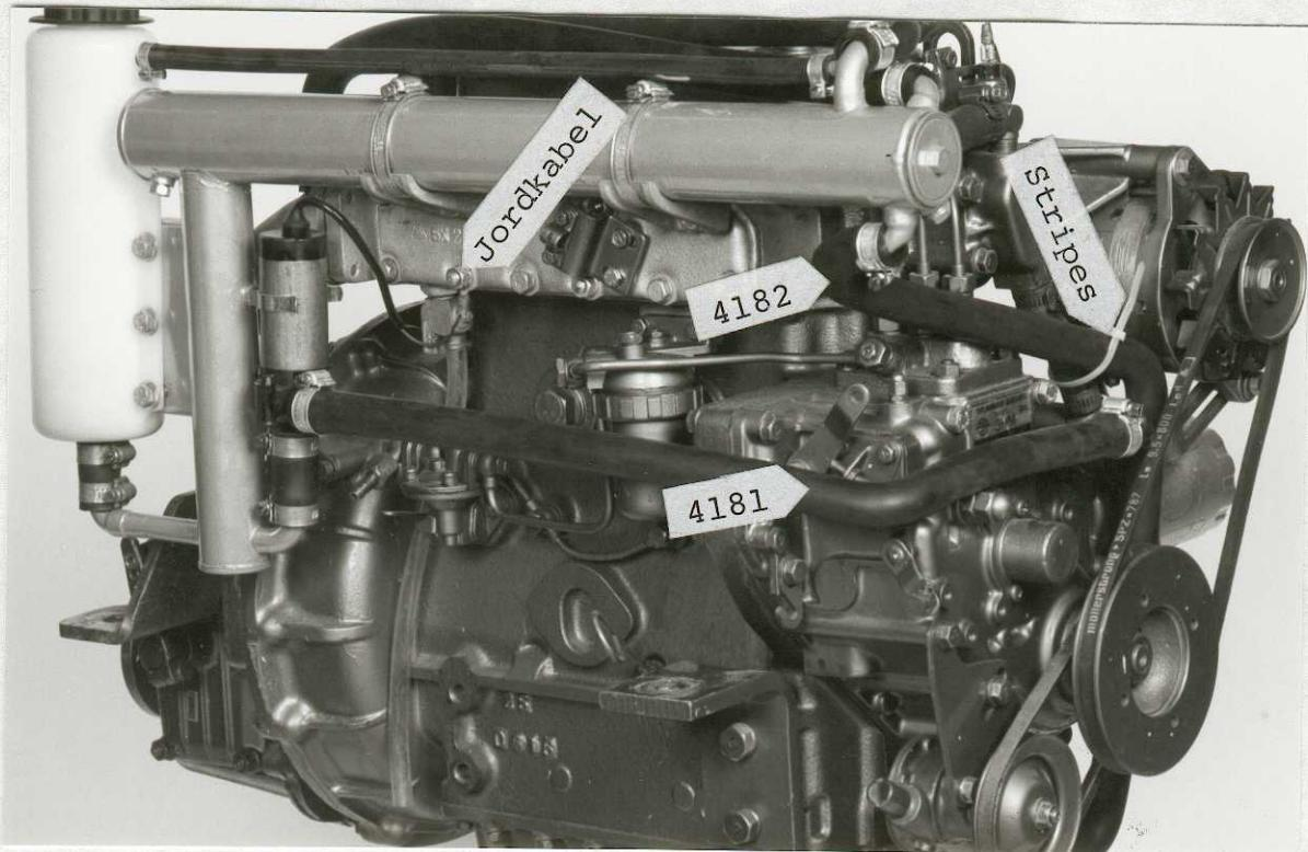
8. Montera den formgjutna slangen nr 4181 från cirkulationspumpens trycksida till 90°-anslutningen riktad åt SB (sötvatten in).
