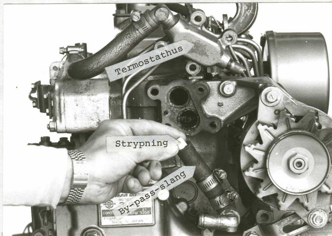
1. Demontera termostathuset och byt ut termostaterna. By-pass-slangen mellan termostathuset och ingående vattenrören i motorn lossas vid termostathuset, och en strypning monteras i slangen. Återmontera termostathuset och by-pass-slangen.
