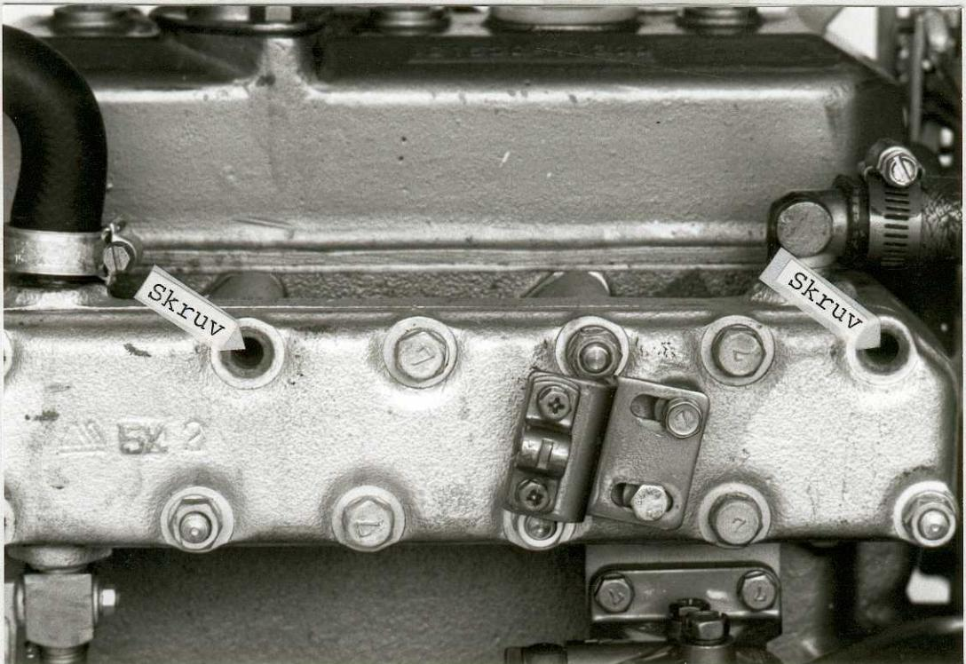
4. Demontera pinnbult nr 1 och 3 på avgassamlarens övre rad. Pinnbultarna lossas genom att använda 2 muttrar på pinnbulten (se bild).
